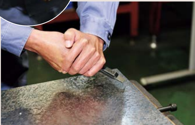
精度を高めるため手作業で、定盤の表面の凸部分を少しずつ削って平らにしてい
